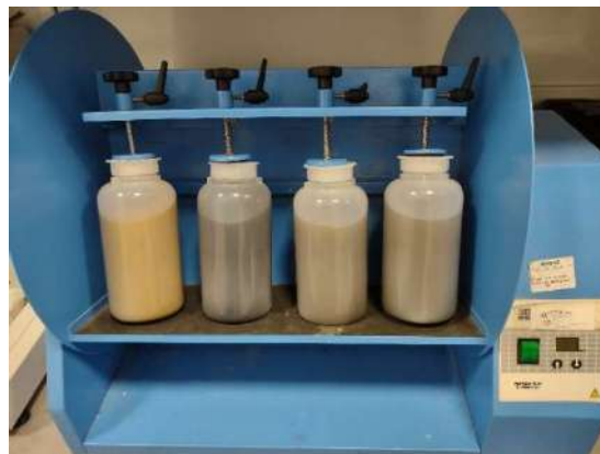
Figura 3: Strumento Rotax per la miscelazione tra rifiuto e reagente
