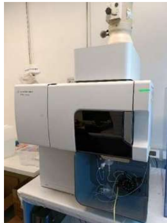
Figura 2: analisi dei prodotti da galvanica mediante ICP-OES 5110
