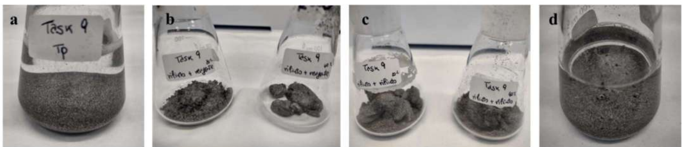
Figura 2: campioni di miscele a) polvere di magnesio in NaOH 0.2 M, b). miscele rifiuto + reagente olio industriale (20% e 40%), c). miscele rifiuto + fango di rettifica (20% e 40%), d). miscela rifiuto + sabbia quarzifera (50%)
