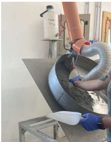
Foto 2. Processo di granulazione in laboratorio presso TEV S.r.l.
