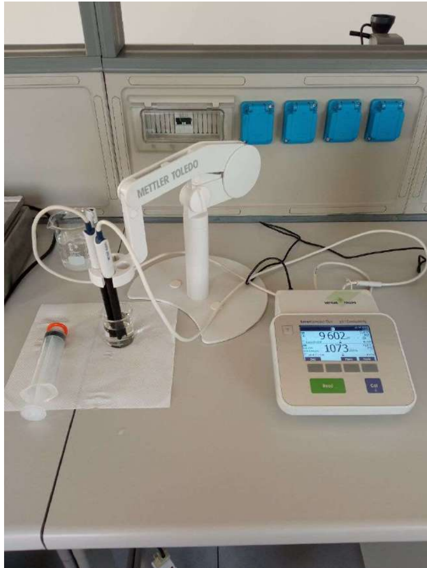
Foto 3. Strumento utilizzato per la misura del pH e della conducibilità
