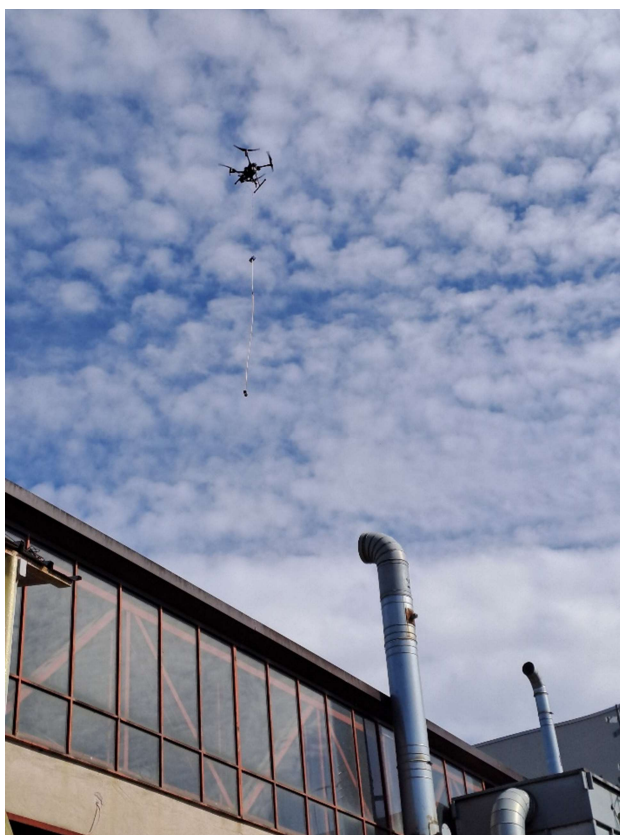
Figura 6: immagini del drone durante il monitoraggio con sensore Gil Air Plus.
