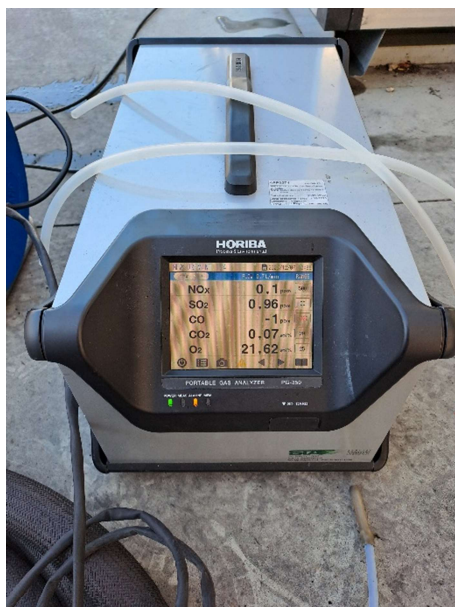
Figura 2 immagine dell'analizzatore portatile di gas Horiba PG-350
