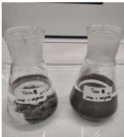
Figura 3: verificata della reattività delle miscele rifiuto+ reagente olio industriale (20% e 40%)
