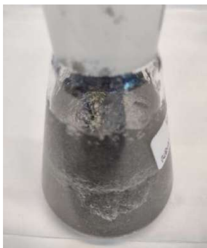
Figura 5:verifica della reattività della miscela rifiuto + sabbia quarzifera (50%)
