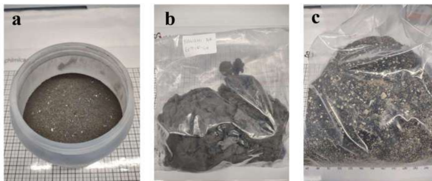
Figura 1: campioni composti da a). Polvere di alluminio, b). Fango di rettifica, c). Sabbia quarzifera
