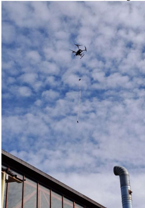
*Figura 9: foto del drone con sensore Air Gil Plus agganciato, nella fase di avvicinamento alla fonte*
