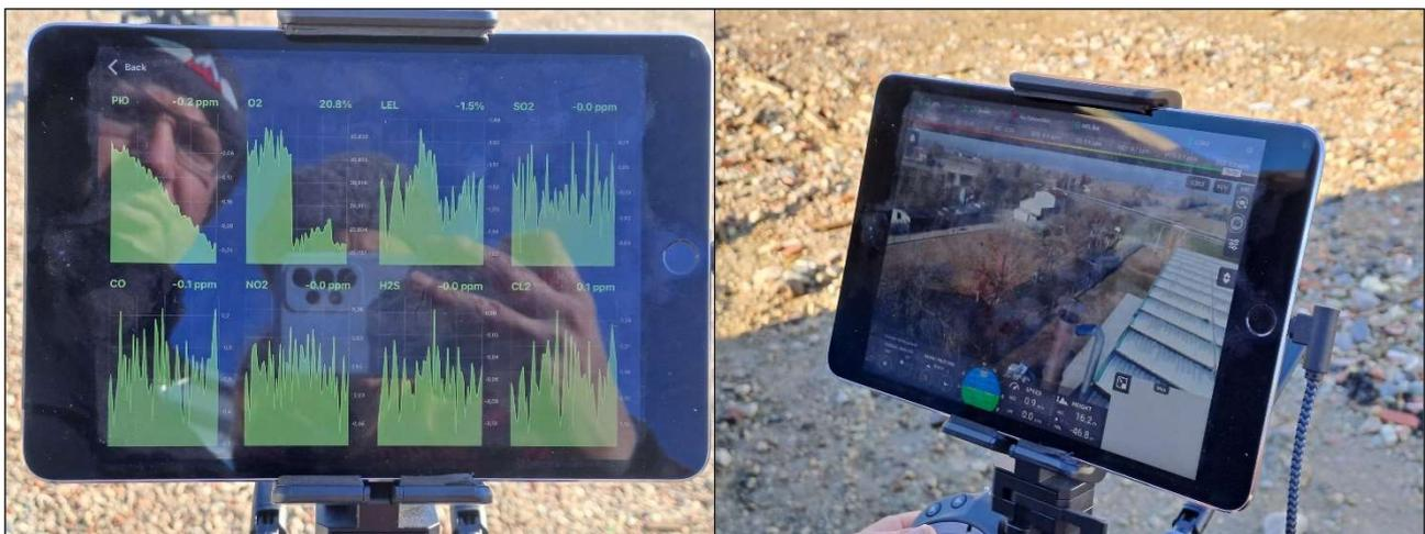
Figura 4: controller del drone in modalità visualizzazione dei sensori online (sx) e video webcam su drone (dx)
